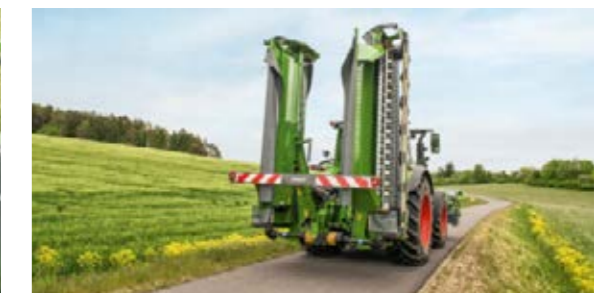
Im geklappten Zustand bleibt die Mähkombination unter 4 m Höhe und kann durch den niedrigen Schwerpunkt komfortabel gefahren werden.
