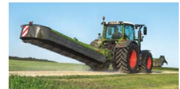
In Transportstellung wird das Mähwerk aus der Kabine um 90° nach hinten geschwenkt.
