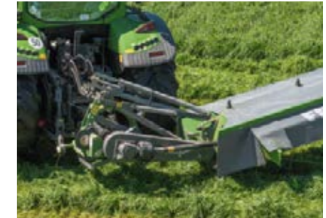
Die Federentlastung sorgt für niedrigen Bodendruck und schont die Grasnarbe.
