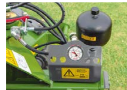
Die hydropneumatische Mähbalkenentlastung TurboLift ermöglicht den einmaligen, schwebenden Schnitt.
