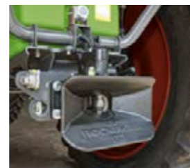
□ Automatisches Zugmaul mit Brems- und Elektroanschlüssen.
