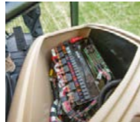
■ Gut erreichbare Zentralelektrik mit den FENDIAS Diagnose Anschlüssen.
