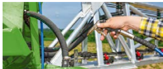
□ Die optionale Druckluftpistole ist hinten am Gestänge angeordnet, für schnelle Reinigung.
