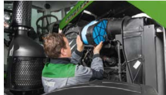
Der Luftfilter lässt sich schnell und unkompliziert herausnehmen.
