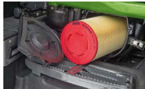
Der Kabinenfilter befindet sich gut erreichbar im Einstiegsbereich und kann bei Bedarf einfach gereinigt werden.
