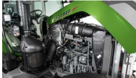
Der Motorraum ist durch die nach oben schwenkbare Motorhaube und die bequem abnehmbaren Seitenteile besonders gut zugänglich.
