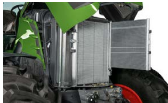
Auch beim Kühler findet man eine gute Reinigungszugänglichkeit vor.
