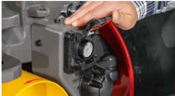
ISOBUS-Schnittstellen Der Fendt 700 Vario verfügt sowohl im Heck als auch in der Front über eine ISOBUS-Steckdose.
