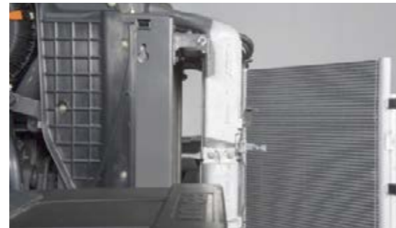
Auch beim Kühler findet man eine gute Reinigungszugänglichkeit vor.
