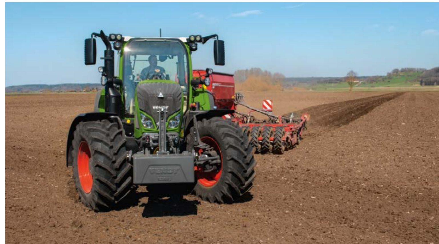
Das Topmodell - der Fendt 724 Vario - erreicht sein maximales Drehmoment von 1.072 Nm bereits bei 1.500 U/min.
