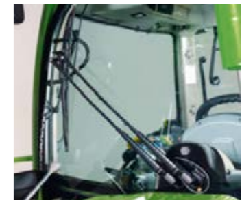
Zwei Scheibenwischer zur Auswahl: Entweder der Segment-Scheibenwischer mit Intervallschaltung oder Parallel-Scheibenwischer sorgen für ein noch größeres Wischfeld.
