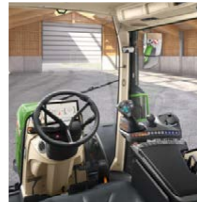
Power Setting 2 - Kreuzschalthebel - kein Linearmodul (Rockerpaar)
