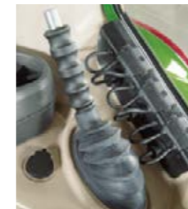
Für Kabel, die vom Heck in die Kabine geführt werden müssen, bietet Fendt eine ausgeklügelte Lösung an. Unabhängig vom Querschnitt kann jedes Kabel sauber durch die Durchführung verlegt werden. Die Heckscheibe kann dabei geschlossen werden und Staub, Schmutz, Wasser und Geräusche bleiben draußen.
