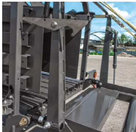
■ Die Sensoren der Ballenwaage zwischen der Presskammer und Ladeschurre messen genau das Gewicht des Ballens und senden die Daten gleich weiter zu Ihrem Terminal. Durch die integrierte Verkabelung im Chassis ist das System geschützt und Kabel können nicht so leicht herausgerissen werden.
