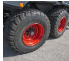
■ Die nachlaufgelenkte Tandemachse garantiert eine große Aufstandsfläche bei hoher Wendigkeit.
