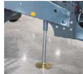
□ Der optional erhältliche hydraulische Stützfuß ermöglicht ein einfaches und schnelles An- und Abhängen des Traktors.
