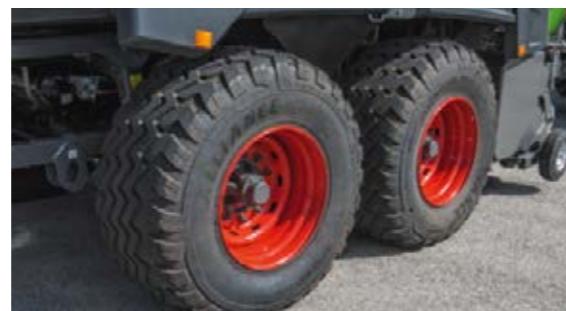
■ Die Fendt Squadra 1290 UD ist für eine Außenbreite unter drei Metern mit zwei unterschiedlichen Bereifungen verfügbar: 620/50R22,5 oder 620/55R26,5.
