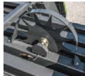
■ Einfaches Anpassen mit der elektrischen Ballenlängenverstellung.
