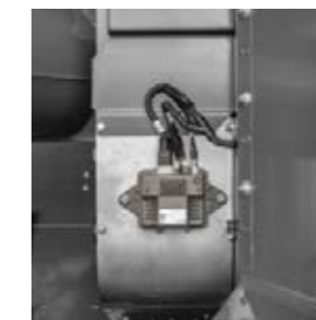
Ertrag, Feuchte und Qualität immer im Blick dank den Live-Daten vom Feld: Sensoren für Ertrag und Feuchte sowie die Kornqualitätskamera sind am Elevator angebracht. Die Daten erreichen eine Genauigkeit von 98 % und werden dank ISOBUS Standard von VarioDoc, Live Ertragskartierung und IDEALharvest™ genutzt.
