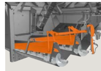
Abdeckklappen über den Schnecken im Korntankboden steuern die Entladegeschwindigkeit in fünf Positionen.
