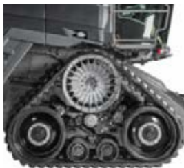
Das Raupenlaufwerk TrakRide sorgt für minimalen Bodendruck.
