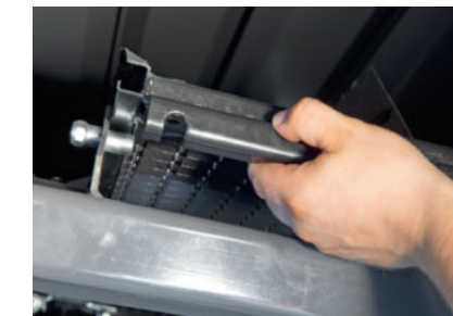
Ausbau der Siebe
