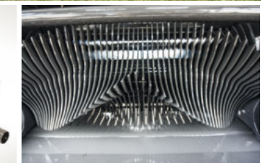
XtraCut25 Rotor - Mit Schneidwerk: bis zu 25 Messer
