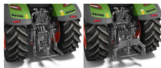
Heckkraftheber mit Kugelenden und Rub Blocks
