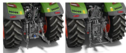
Heckkraftheber mit Schnellfanghaken und Seitenabstützung (EU)
